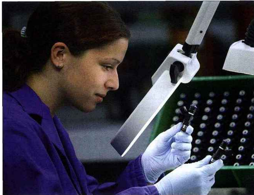
Contrôle qualité d'injecteurs à essence produits chez Bosch (Phot. Bosch).
